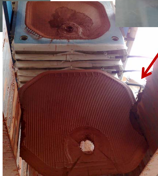
Lama vermelha em forma de torta para disposição a seco ( dry stacking )
