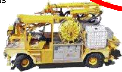
Robôs de Projeção de concreto
