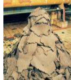
Lama de Esgoto
