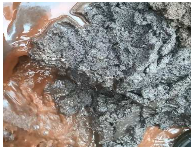
Sólidos carregados pela espuma no espessador de rejeitos.
