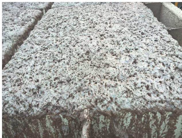
Rejeito da flotação reversa da sílica. Espuma inerente ao processo.
