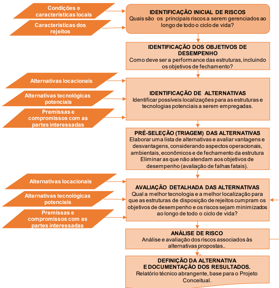
Figura 4.1 – Processo de seleção de alternativas para sistemas de disposição de rejeitos (adaptado de MAC, 2017).
